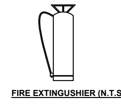
FIRE EXTINGUISHER (N.T.S)
