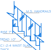
STAIRCASE DETAILS SCALE: 1:20
